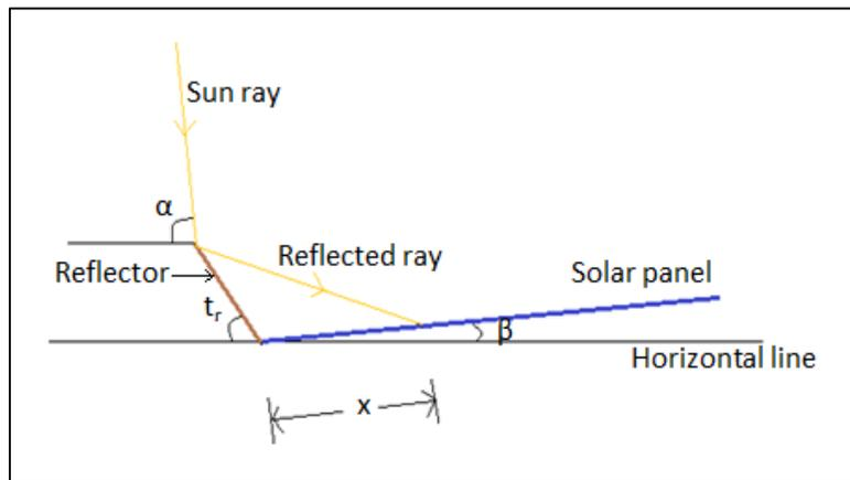
Fig. 8: Reflector Orientation
